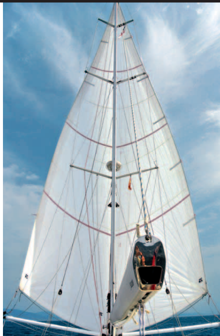
Klassische Passatstellung, ohne Großsegel. Die Ausbaumer sind nur halb so lang wie das Unterliek und daher sehr handlich
