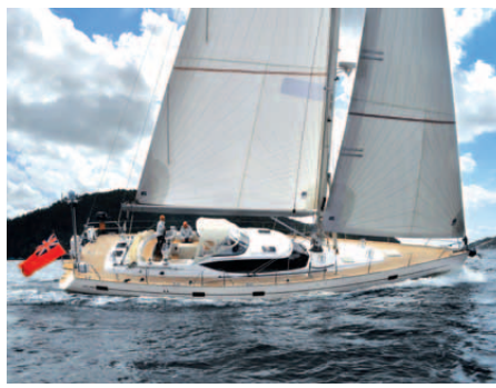
Am Wind liegen die Focks aufeinander, sie werden zusammen bedient. Holepunkte und Winschen sollten doppelt vorhanden sein
